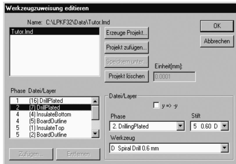
Im Allgemeinen werden die Produktionsdaten durch Importieren im Menü Datei eingelesen. Diese Projekte können jedoch auch an dieser Stelle zugefügt (LMD-Datei von *CircuitCAM*) oder erzeugt (HP-GL Dateien) werden.
